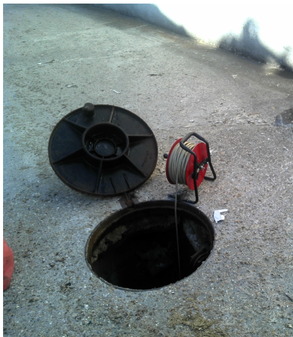
Fotografia 1| Sonda de nível utilizada nos ensaios de caudal (Poço PT)
